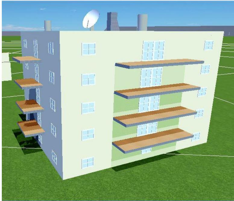
Bild 3: Beispiel eines Referenzgebäudes mit Flachdach nachgebildet in PVsol, welches vor allem in städtischen Gebieten vorzufinden ist. Der Einbau einer Guerilla-Anlage wird vor allem am Balkongeländer realisiert. Der Einfluss von Verschattung vor allem bei überliegenden Balkonen ist ausschlaggebend für Ertragsminderungen.
